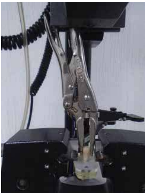
Figura 1. Imagen representativa de la ejecución de la pruebas de resistencia al desalajo en tensómetro universal.
